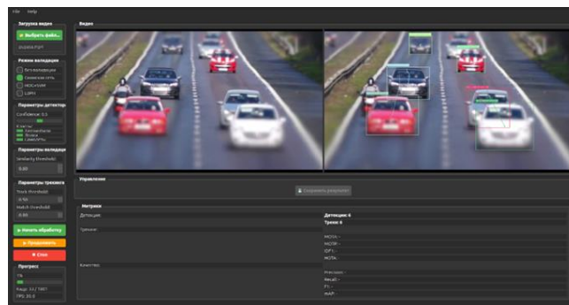
Рисунок 3 – Механизм отслеживания быстро движущихся объектов в разработанном программном обеспечении
