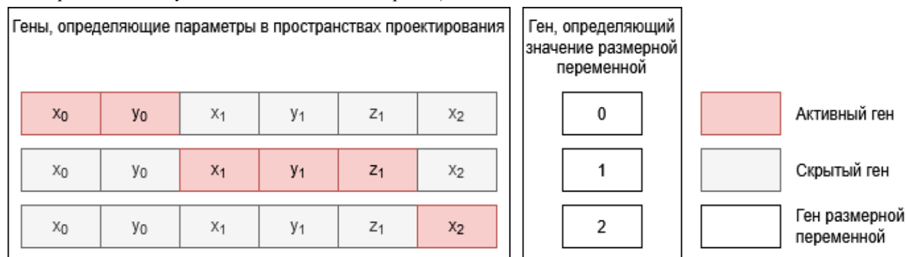
Рис. 1. Визуализация отношений гена, кодирующего размерную переменную, и генов, определяющих параметры в пространстве проектирования
